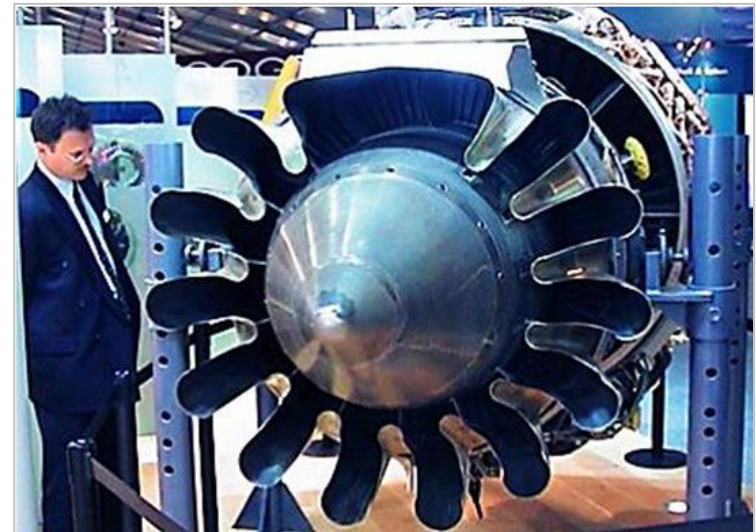
Tvárnenie explóziou – aplikácia v priemysle (turbína firmy Exploform)
