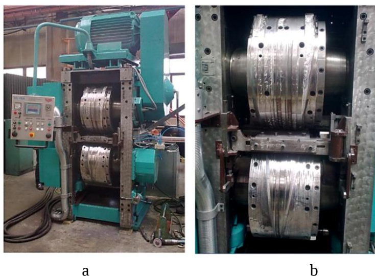
Obr. 1.5. Valcovačka UL 45 A na priečne klinové valcovanie (Ludrovcová, 2017) a – celkový pohľad na valcovačku, b – pohľad na valce s pripevnenými segmentmi na valcovanie hriadeľa
