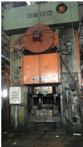
Obr. 1.16. Zvislý kovací lis LZK 2 500 použitý na kovanie hriadeľa
