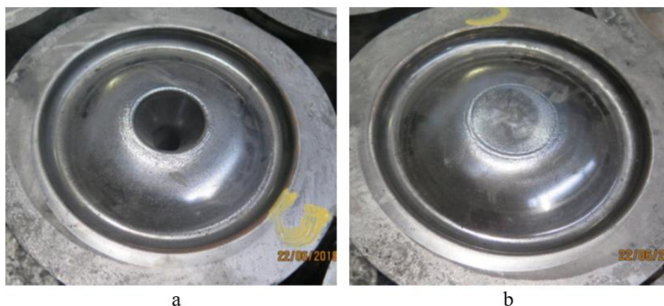
Obr. 2.13. Pohľad na dolnú časť zápusťky (vzorka 3) iónovo nitridovanej po vykovaní 600 ks (a), pohľad na hornú časť zápusťky (vzorka 3) iónovo nitridovanej po vykovaní 600 ks výkovkov (b)
