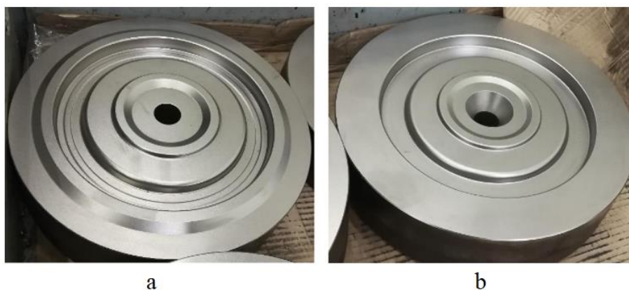
Obr. 2.5. Pohľad na dokončovaciu zápustku po gulôčkovaní a – horná časť dutiny dokončovacej zápustky, b – dolná časť dutiny dokončovacej zápustky
