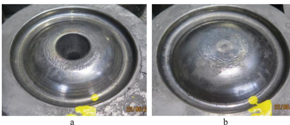
Obr. 2.12. Pohľad na dolnú časť zápusťky (vzorka 2) nitridovanej v plynnom prostredí po vykovaní 600 ks (a), pohľad na hornú časť zápusťky (vzorka 2) nitridovanej v plynnom prostredí po vykovaní 600 ks výkovkov (b)
