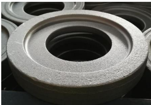
Obr. 2.6. Pohľad na výkovok kola diferenciálu
