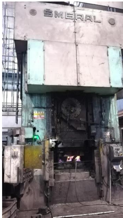
Obr. 2.2. Kovací lis LZK 2 500/4
