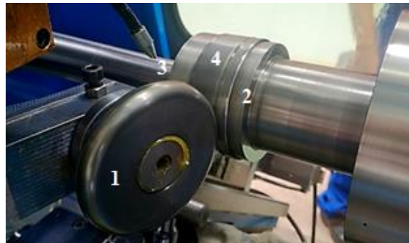
Obr. 3.1. Proces tlačenia 1 – kladka, 2 – model, 3 – upínací prípravok, 4 – výtvarok
