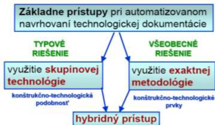
Obr. 4 Základná klasifikácia prístupov pri automatizovanom návrhu VP
