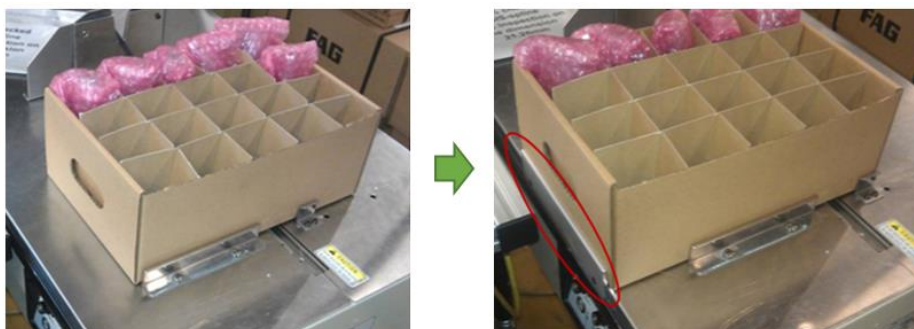
Obr. 9.16. Optimalizácia – páskovanie krabice, presná pozícia na dorazy (Schaeffler Skalica)
