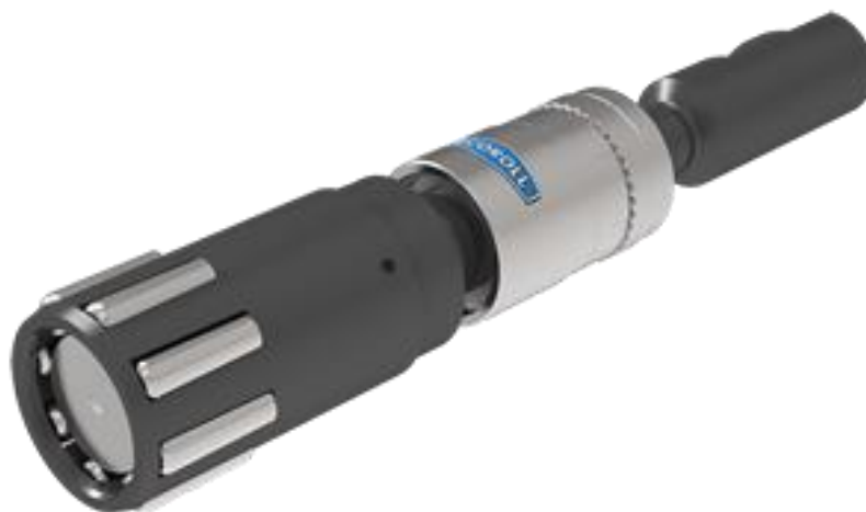
Obrázok 9 Nástroj slúžiaci na technológiu valčekovania (TrigoN Tools 2020)
