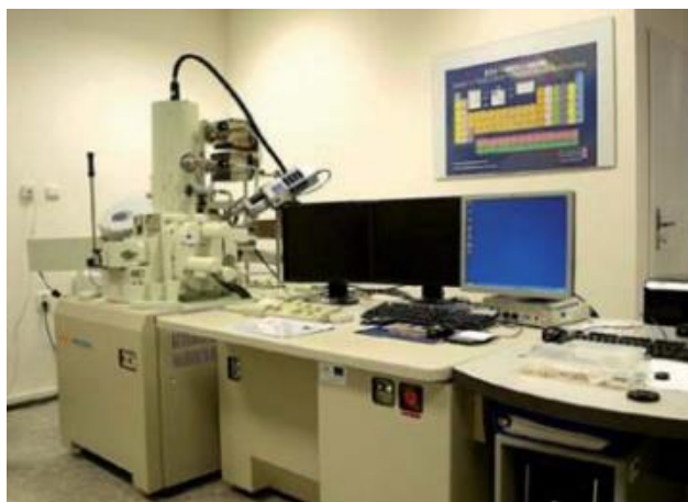
Obrázok 32 Vysokorozlišovací rastrovací elektrónový mikroskop s detektormi (Čaplovič 2010)
