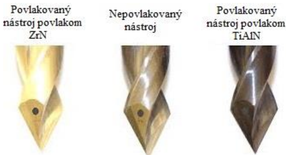
Obrázok 6 Porovnanie povlakovaných nástrojov rôznymi povlakmi (Szwajka et al. 2019)
