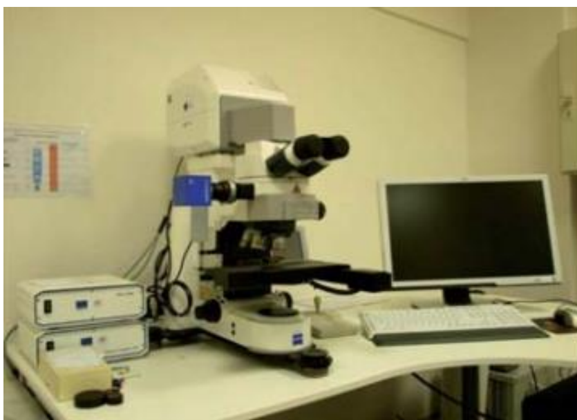
Obrázok 27 Laserový konfokálny mikroskop ZEISS LSM 700 (Čaplovič 2010)
