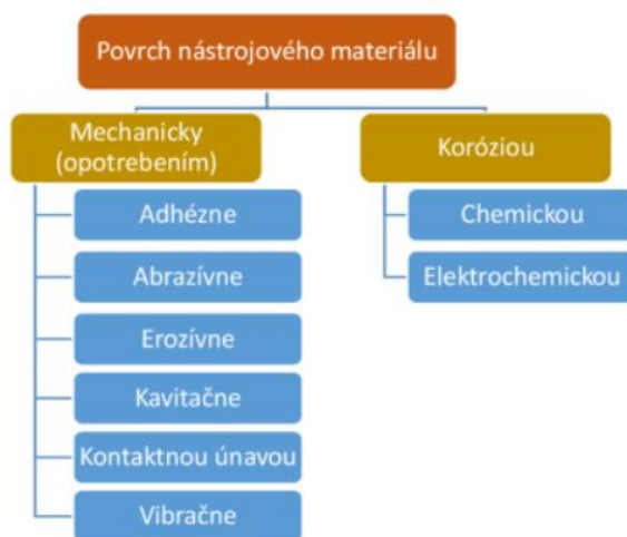
Obr. 44 Schematické znázornenie druhov poškodenia povrchov kovacích zápustiek (Kovové materiály, 2004).
