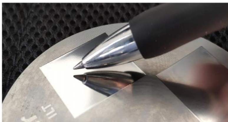
Obr. 18 Fotografia vzorky (AISI H11) s plochou 20 x 25 mm vyleštenou laserom (Temmler et. al., 2020).
