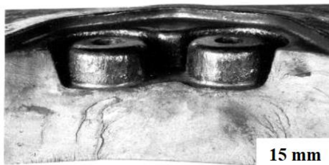
Obr. 45 Nízkocyklová únava kovacej zápustky vyvolaná tepelno – mechanickým zaťažením (Hazlinger a kol., 2010).
