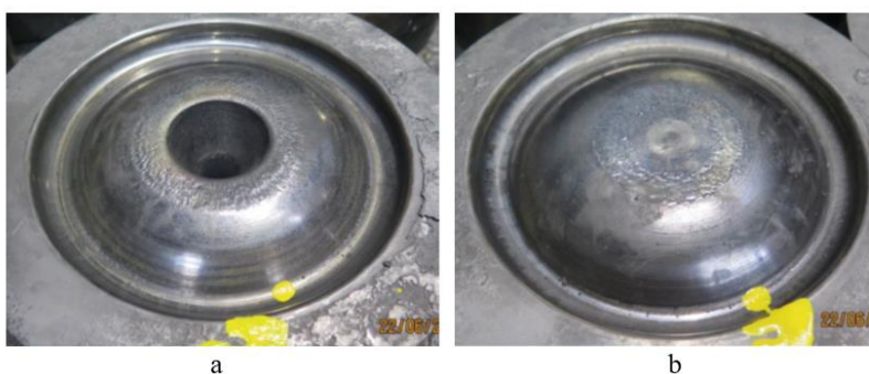
Obr. 2.12. Pohľad na dolnú časť zápustky (vzorka 2) nitridovanej v plynnom prostredí po vykovaní 600 ks (a), pohľad na hornú časť zápustky (vzorka 2) nitridovanej v plynnom prostredí po vykovaní 600 ks výkovkov (b)
