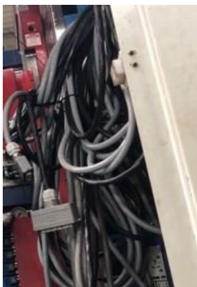
Obr. 10.6. Zapájanie káblov na ohrev formy v súčasných podmienkach (Rašková, 2020)
