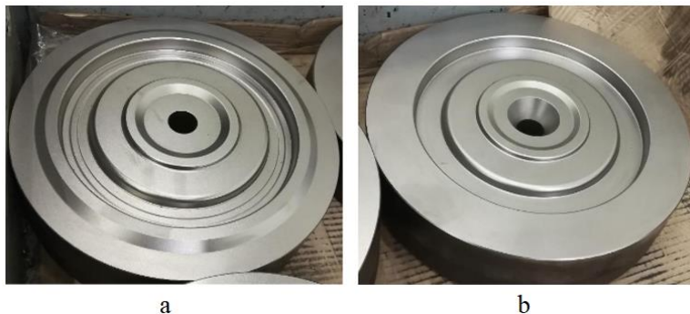
Obr. 2.5. Pohľad na dokončovaciu zápustku po gulôčkovaní a – horná časť dutiny dokončovacej zápustky, b – dolná časť dutiny dokončovacej zápustky
