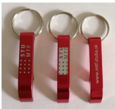
Obr. 4.24. Kľúčenky s logom a webom MTF STU, vyrobené laserovým značením
