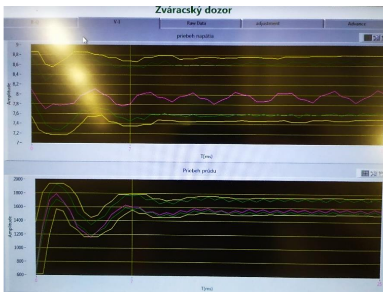
Obr. 7.20. Priebeh zvarovania – napätie a prúd (Interné dokumenty Schaeffler Skalica, 2020)
