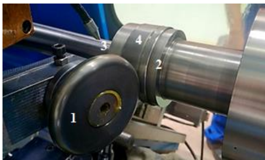
Obr. 3.1. Proces tlačenia 1 – kladka, 2 – model, 3 – upínací prípravok, 4 – výtvarok
