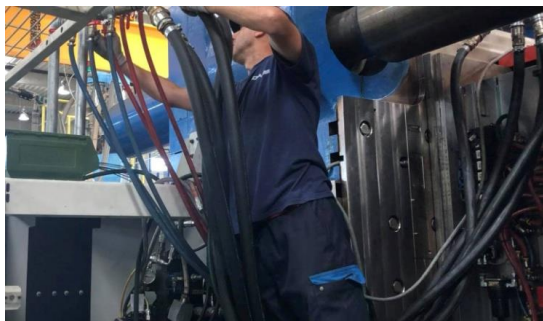
Obr. 10.5. Odpájanie káblov na vodu formy č.1 (Rašková, 2020)
