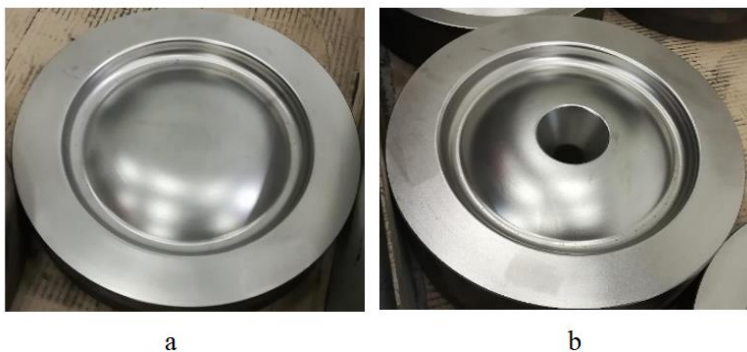
Obr. 2.4. Pohľad na predkovaciu zápustku po gulôčkovaní a – horná časť dutiny predkovacej zápustky, b – dolná časť dutiny predkovacej zápustky
