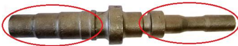
Obr. 1.11. Oblasti hriadeľov, z ktorých boli vyrobené skúšobné vzorky na ťahové skúšky
