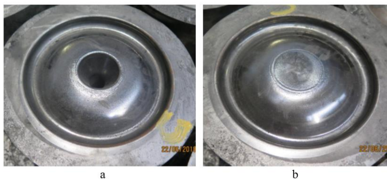
Obr. 2.13. Pohľad na dolnú časť zápustky (vzorka 3) iónovo nitridovanej po vykovaní 600 ks (a), pohľad na hornú časť zápustky (vzorka 3) iónovo nitridovanej po vykovaní 600 ks výkovkov (b)
