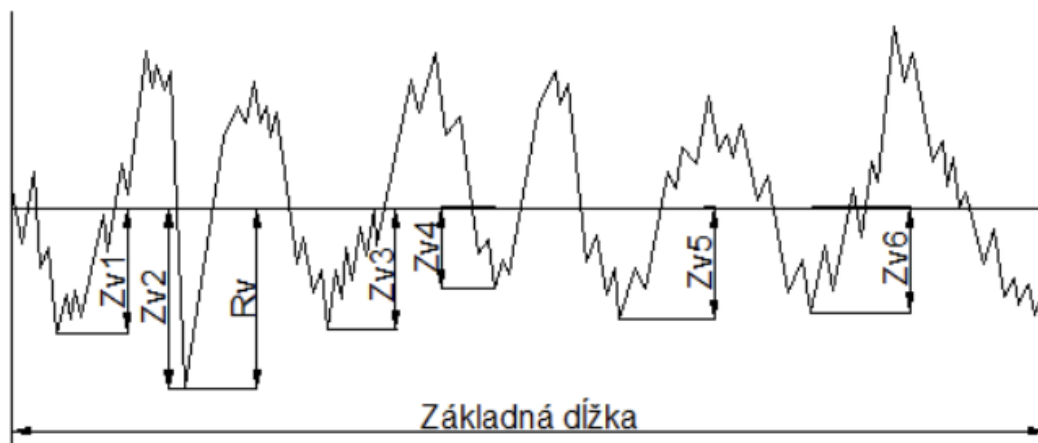
Obrázok 20 Najväčšia hĺbka priehlbiny profilu R_v (Görög, Samardžiová, 2016)
