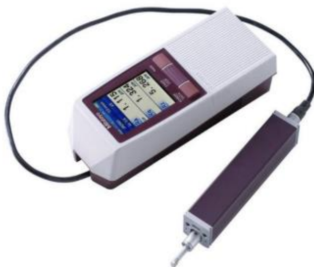
Obrázok 17 Drsnomer Mitutoyo SJ 210
