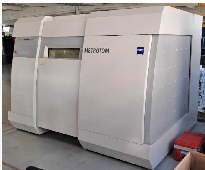
Obr. 35 CT skener Metrotom 1500 nachádzajúci sa na pôde fakulty
