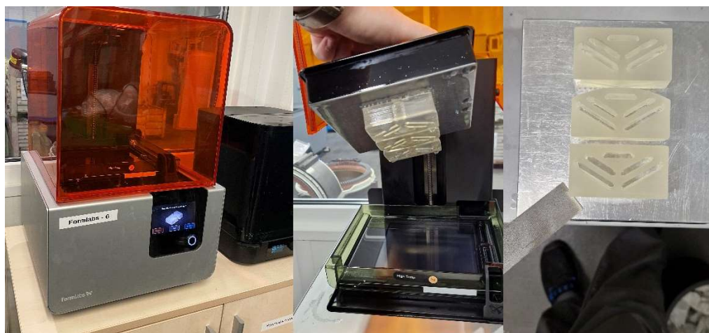
Obr. 50 Proces 3D tlače vzoriek rotora
