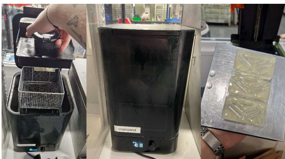
Obr. 51 Proces oplachovania 3D vzoriek rotora
