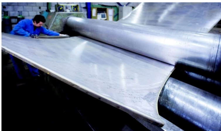
Obr. 38 Valcovanie plechu (Fimosteel 2024)
