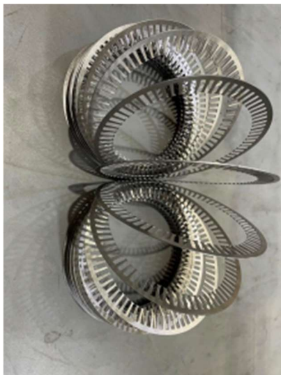
Obr. 12 Lamela vyrobená pomocou technológie Slinky design
