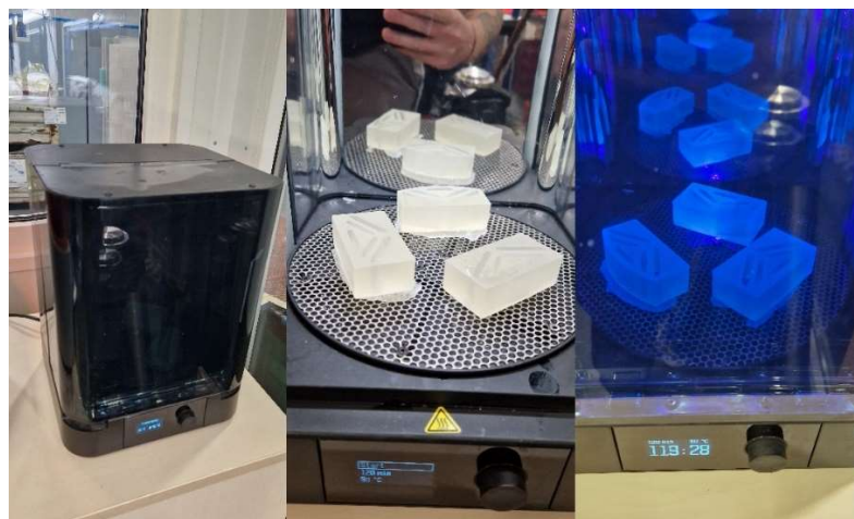
Obr. 52 Proces vytvrdzovania 3D vzoriek rotora
