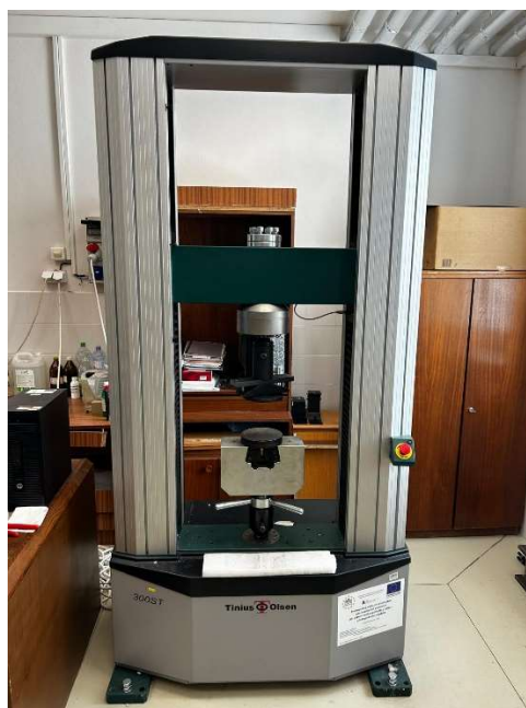
Obr. 62 Trhacie zariadenie Tinius Olsen MODEL 300ST
