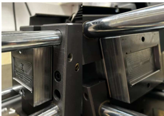
Obr. 57 Upnutie prvej a druhej časti vstrekovacej formy
