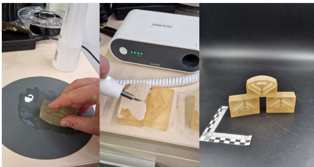
Obr. 53 Proces čistenia 3D vzoriek rotora
