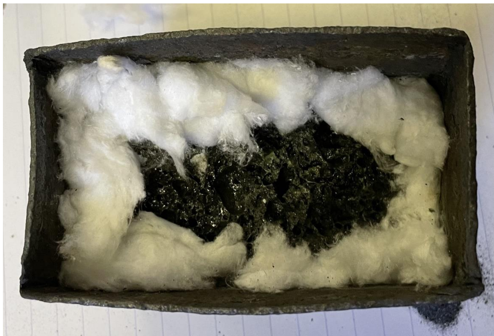
Obrázok 13 Kovová platňa ktorá je po stranách uzavretá hygienickou vatou.
