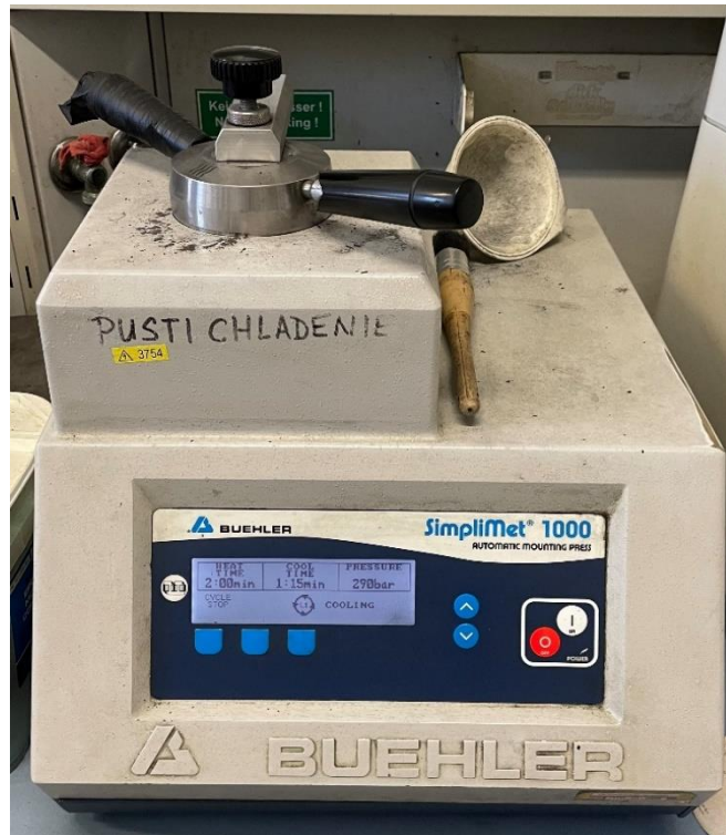
Obrázok 14 Automatický lis značky Buehler - Simplimet 1000
