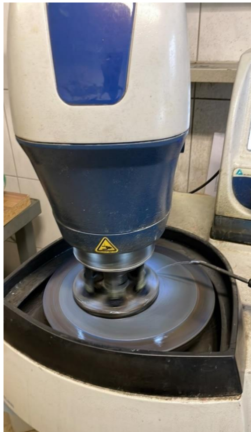
Obrázok 15 Mokrú brúsenie vzoriek na prístroji Buehler EcoMet 300
