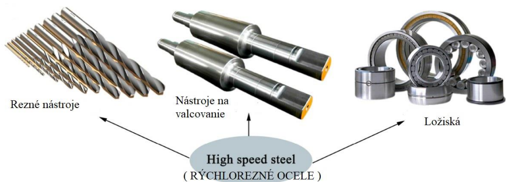
Obrázok 2 Typické aplikácie rýchlorezných ocelí ( Wang 2023 )
