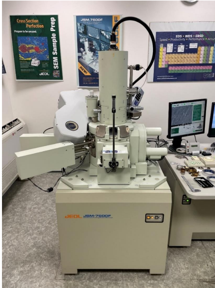
Obrázok 32 Rastrovací elektrónový mikroskop vo vákuovom prostredí - JEOL JSM-7600F
