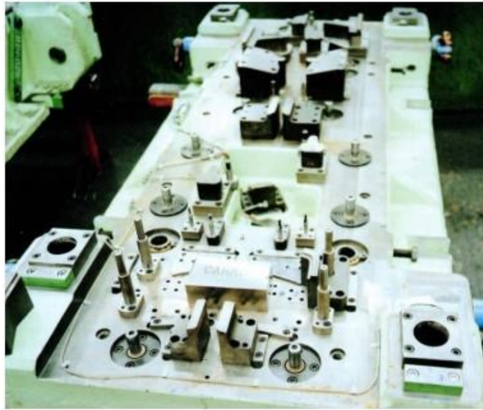
Obrázok 1 Príklad použitia legovaných ocelí - progresívny lisovací nástroj s funkčnými časťami z Cr-V nástrojovej ocele Vanadis 6 ( Jurči, Ptačinová 2022 )
