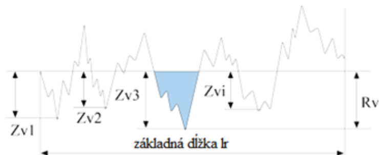
Obrázok 24 Hĺbka najväčšej priehlbiny profilu (OLYMPUS ©2018)
