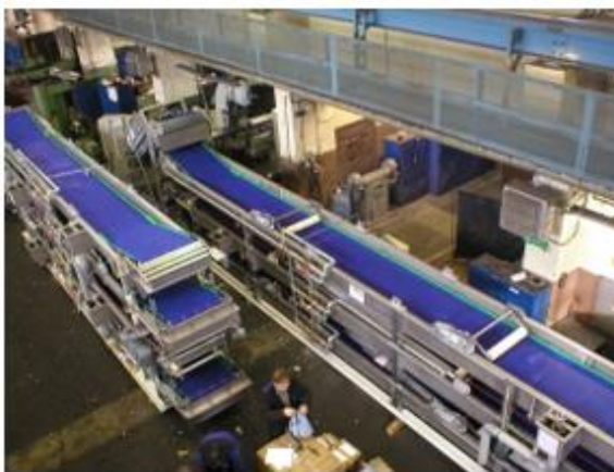
Obrázok 8 Výroba chladiacich a dopravníkových systémov pre vytlačované gumové profily (Bakalárska práca, Zdražilová 2021)
