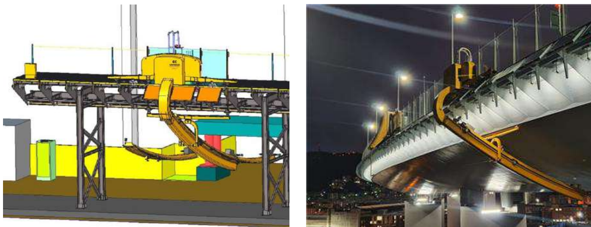
Obr. 8 Robotický systém na moste v Janove ( news-camozzi-com )
