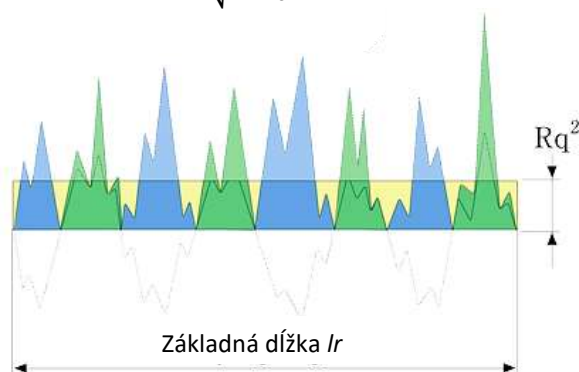
Obrázok 5 Schematické znázornenie strednej kvadratickej odchýlky profilu Rq [9]
