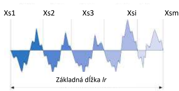
Obrázok 6 Schematické znázornenie priemernej šírky prvkov profilu R_{Sm} [9]
