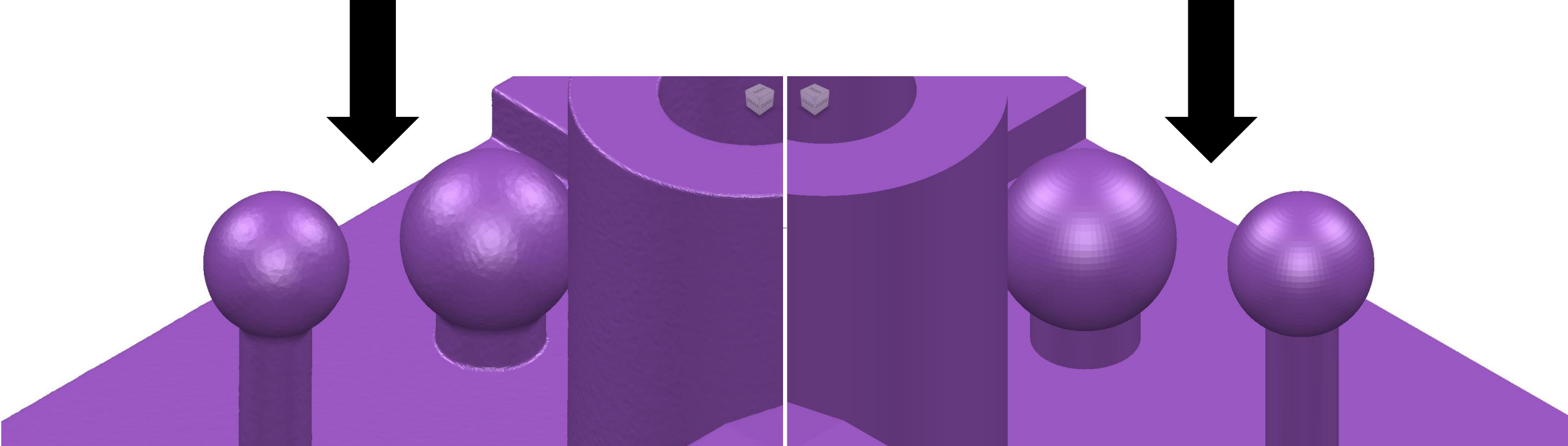
a) Polygonálny model získaný 3D optickým skenovaním 29 7246 bodov, 59 4500 trojuholníkov
