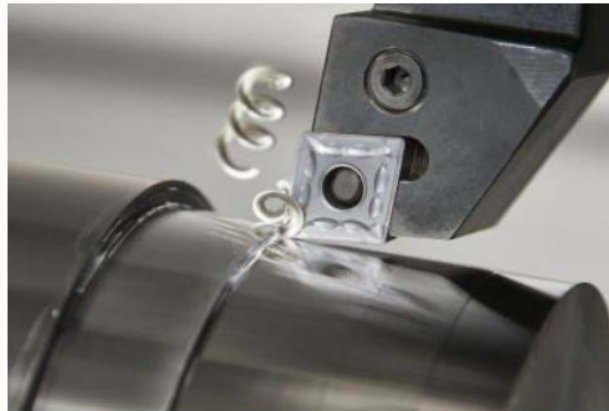
Trieska vznikajúca pri pozdĺžnom sústružení
