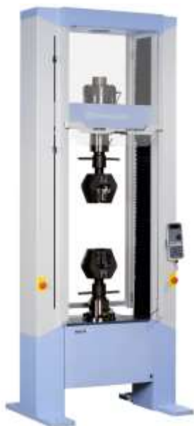
Obrázok 1 Skúšobné zariadenie na skúšku jednoosovým ťahom
