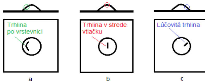
Obrázok 2.4 Tvar trhliny pri skúške hĺbením podľa Erichsena
