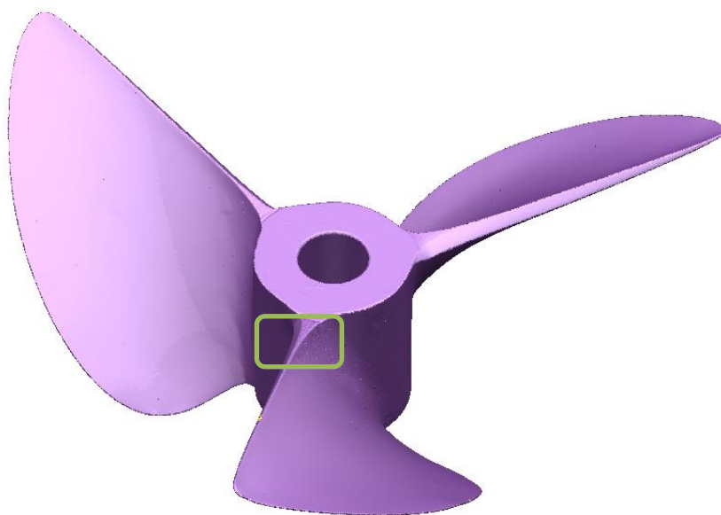
Obr. 77 Polygonálny 3D model lodnej skrutky
