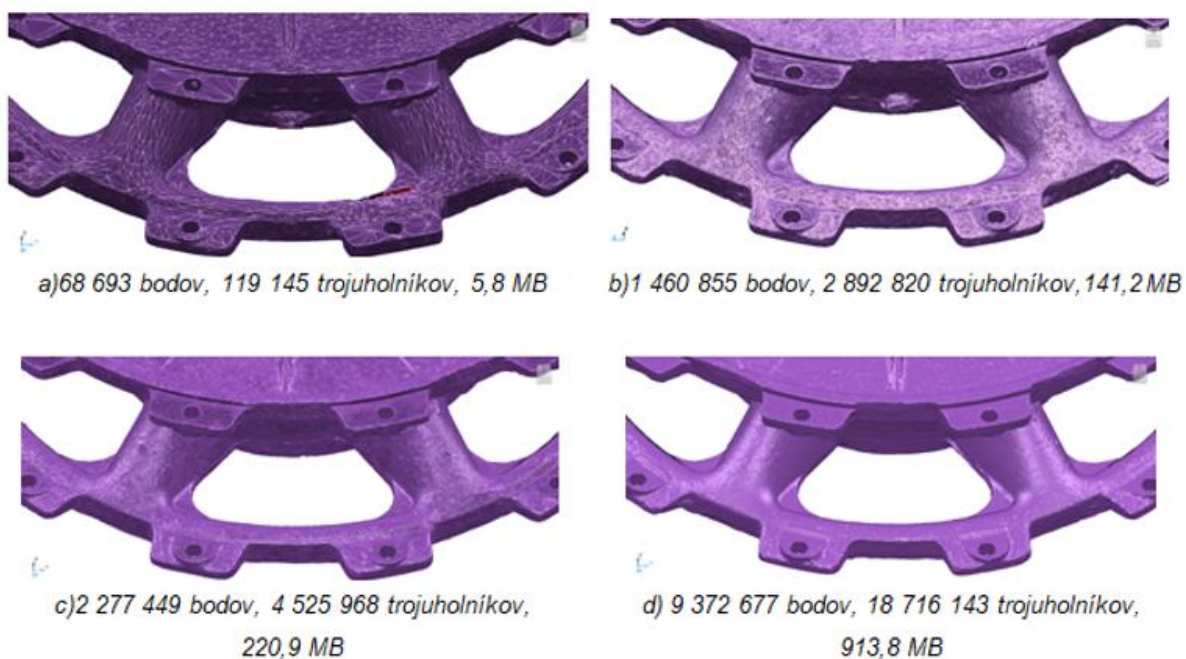
Obr. 74 Detail polygonálneho modelu kola historického tanku
