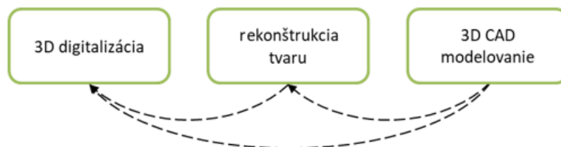
Obr. 30 Tri hlavné etapy reverzného geometrického modelovania [33]
