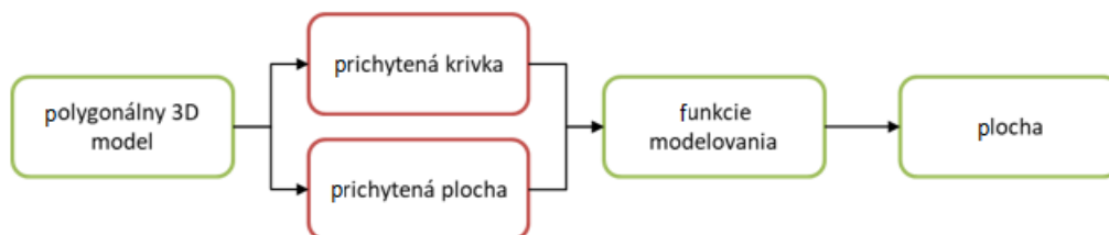
Obr. 48 Prichytená krivka a plocha v reverznom geometrickom modelovaní
