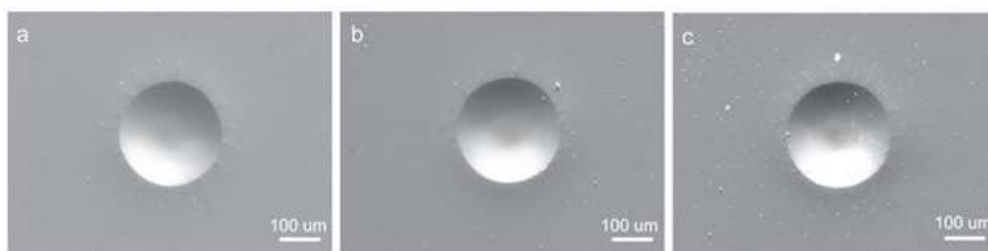
Obr. 3.20. Vyhodnotenie adhézie povlakov po skúške „Mercedes test“ a – vzorka 1 (HF1), b – vzorka 2 (HF1), c – vzorka 3 (HF1)
