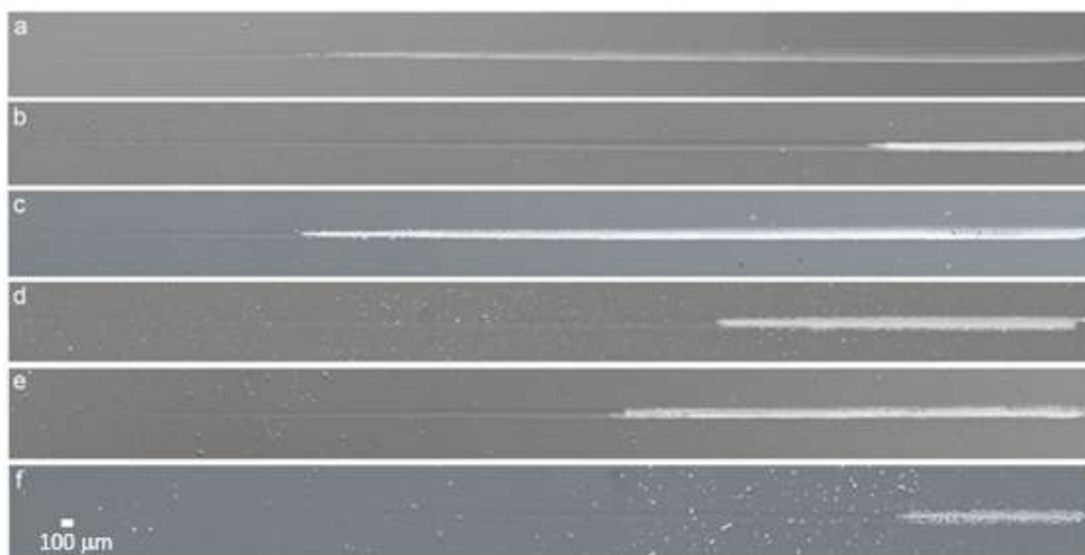
Obr. 3.23. Výhodnotenie adhézie povlakov po skúške „Scratch test“ a – vzorka 1, b – vzorka 3, c – vzorka 4, d – vzorka 6, e – vzorka 7, f – vzorka 9
