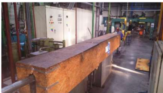
Obr. 2.11. Proces chladenia po pretlačovaní
