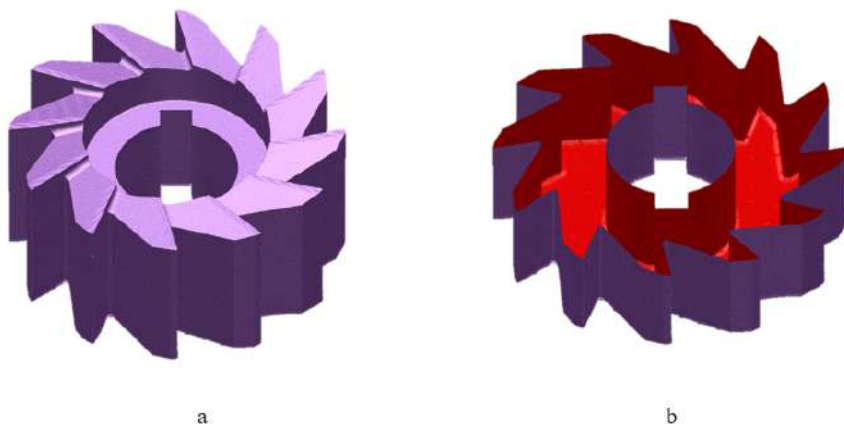
Obr. 9.30. Polygonálny 3D model získaný priemyselným počítačovým tomografom a – čelná valcová fréza vyrobená aditívnou technológiou SLA (273 MB (286 511 104 bajtov)), b – rez čelnou valcovou frézou vyrobenou aditívnou technológiou SLA
