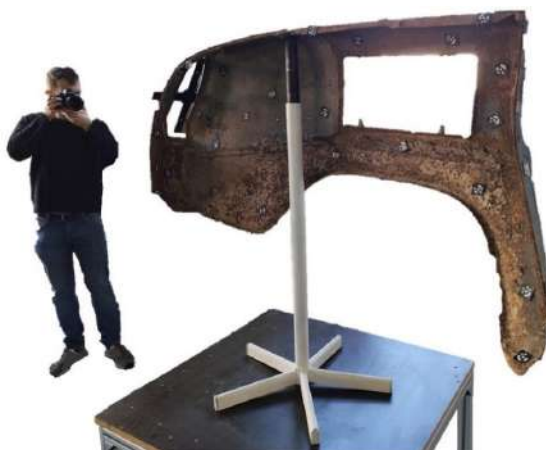
Obr. 8.12. Realizácia fotogrametrického merania (GOM TRITOP – Nikon D300s) – snímame kódovaných a nekódovaných referenčných bodov
