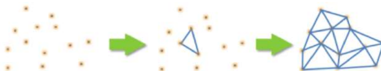
Obr. 8.16. Polygónová sieť vytvorená trianguláciou mraku bodov (3D Systems, 2014; Očenáš, 2015)
