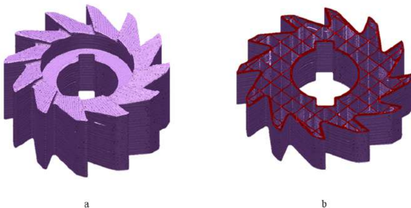
Obr. 9.31. Polygonálny 3D model získaný priemyselným počítačovým tomografom a – čelná valcová fréza vyrobená aditívnou technológiou FDM (949 MB (995 524 608 bajtov)), b – rez čelnou valcovou frézou vyrobenou aditívnou technológiou FDM
