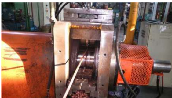
Obr. 2.7. Vstup materiálu (polotovaru) do stroja medzi valce na pretlačovanie (Kosztolánszka, 2019)
