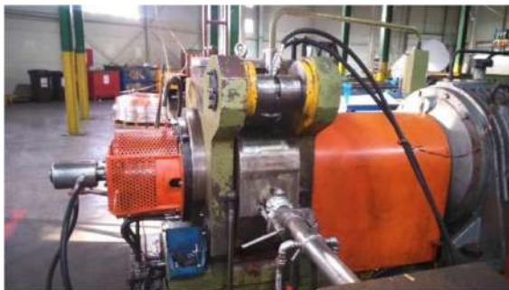
Obr. 2.10. Výstup drôtov z pretlačovacej hlavy a začiatok chladenia
