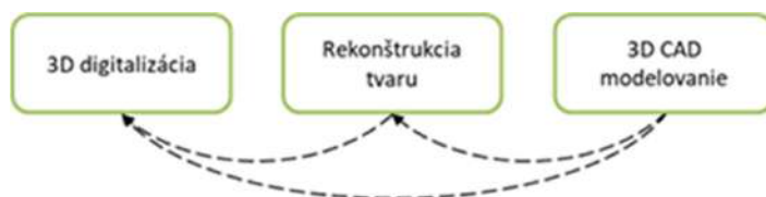
Obr. 9.5. Tri hlavné etapy reverzného geometrického modelovania podľa (Anwer a Mathieu, 2016)
