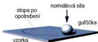
Obr. 3.12. Princíp ball-on-disc skúšky (Stavlid, 2016)
