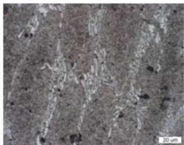
Nástrojová oceľ Vanadis 23 vyrobená metódou práškovej metalurgie
