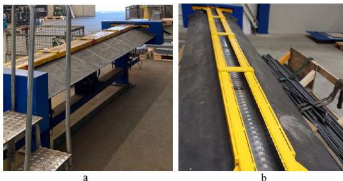
Obr. 7.11. Vyčistenie reťazového dopravníka SKB-T190 (Jurčová, 2024) a – stav pred vyčistením, b – stav po vyčistení
