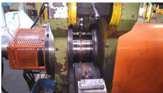
Obr. 2.8. Pohľad na otvorenú výstupnú časť pretlačovacieho zariadenia s odklopným špeciálnym nástrojom (otvorený stroj) (Kosztolánszka, 2019)
