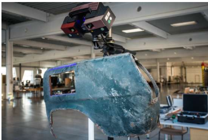
Obr. 8.14. 3D skenovanie blatníka metódou aktívnej triangulácie štruktúrovaným svetlom (GOM ATOS II TripleScan SO MV 320) (Urban, 2025)
