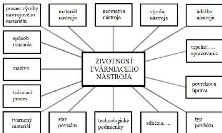
Obr. 4.4. Parametre, ovplyvňujúce životnosť tváriaceho nástroja (Zdravecká, Tkáčová a Tkáč, 2009)
