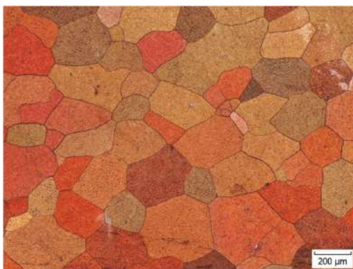
Obr. 2.13. Mikroštruktúra elektrotroskovo pretavovanej medi (ETP) pred pretlačovaním
