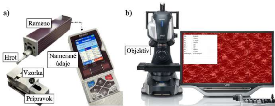
Obr. 5.11. Meranie drsnosti a – kontaktným profilometrom, b – digitálnym mikroskopom
